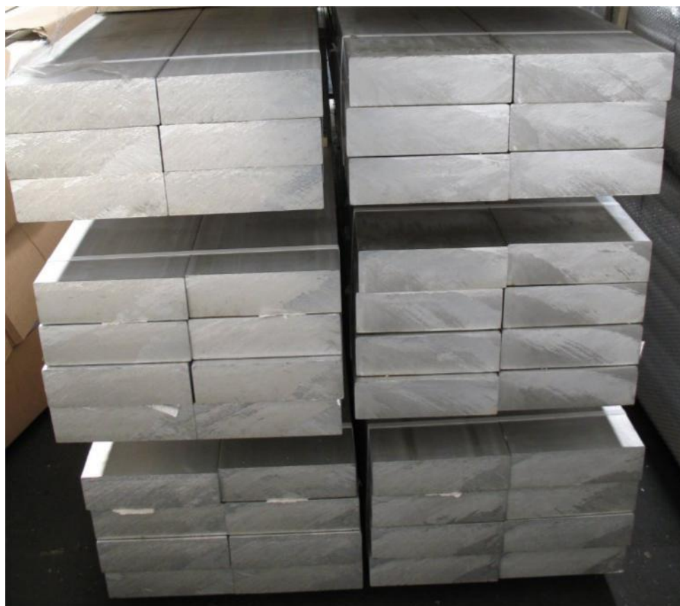
FOTO DI ESEMPIO: PROFILI IN ALLUMINIO ESTRUSO PIATTI DI GRANDI DIMENSIONI LEGA 6060 - 6082
